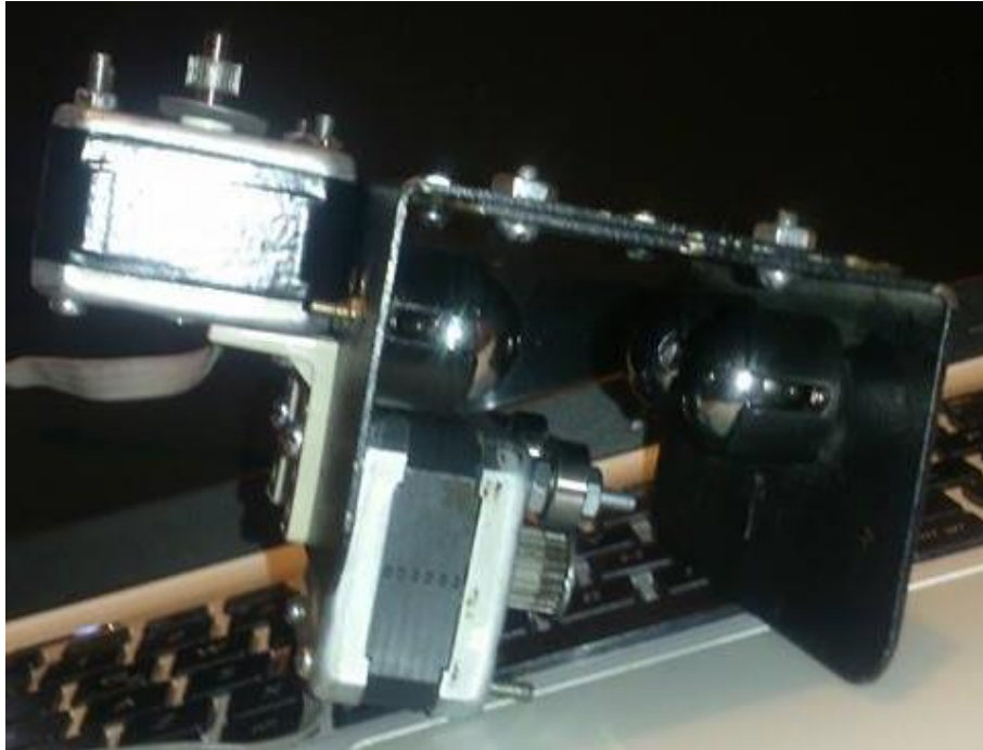
Figura 34 Primer prototipo 2 motores integrados
